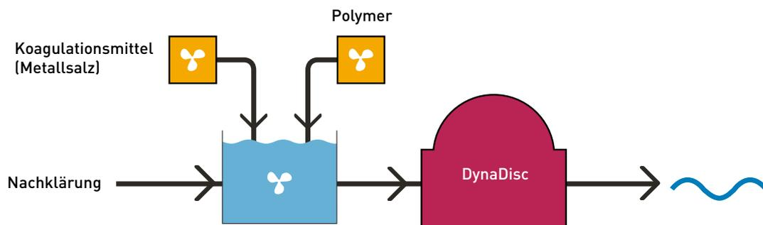
Beispiel eines Fließdiagramms für Nordic® ZeroP
