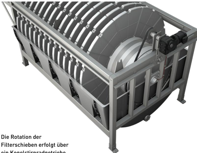
Die Rotation der Filterscheiben erfolgt über ein Kegelstirnradgetriebe, welches einen korrosionsfreien kohlefaserverstärkten Zahnriemen antreibt.
