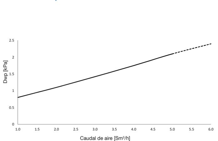
Agua potable limpia, condiciones estándar (+ 20 °C, 101,3 kPa), nivel TDS 1000 mg/l, profundidad de inmersión 4 m, densidad del difusor, DD = área total del difusor / área total del fondo
