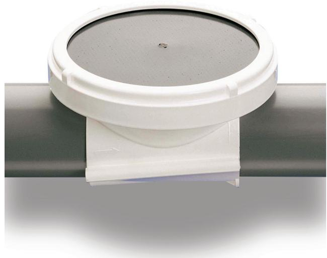
Cuando se apaga el caudal de aire, la presión del agua situada encima aprieta el disco de la membrana firmemente contra la base de soporte para cerrar las pequeñas rendijas en la membrana. La válvula de retención se cierra y garantiza que no se introduzca agua en la tubería.
